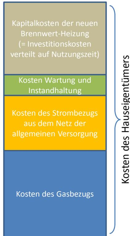
Jährliche Kosten für Wärme und Strom bei Nutzung eines Mikro-BHKW im Contracting
